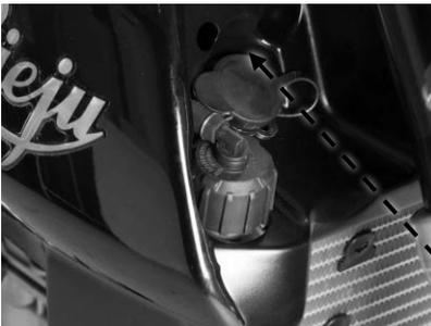
Um den Kühlmittelstand zu prüfen, lösen Sie den Ausgleichsbehälterdeckel ② und prüfen Sie den Kühlmittelstand. Wenn es leer ist, den Kühlerschlussdeckel lösen und bis zur Mitte des Ausgleichsbehälters auffüllen.
