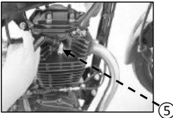
④ Lassen Sie die Zündkerze in Reinigungsmittel oder in Benzin für 5 bis 30 Minuten und entfernen Sie dann die Ablagerungen mit einer nichtmetallischen Bürste; schließlich mit Benzin waschen.
