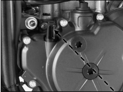
Um den Ölstand zu prüfen, muss der Motor kalt sein und das Motorrad waagrecht stehen.
