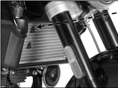
Der Kühler ① ist an der Vorderseite des Motorrades unterhalb des Scheinwerfers angebracht.
