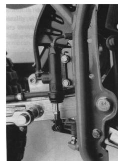
Die Einstellung des Leerspiels erfolgt mittels einer Rändelmutter am hinteren Bremsgestänge. Für den Wechsel der Bremsflüssigkeit gehen Sie wie vorher beschrieben vor.
